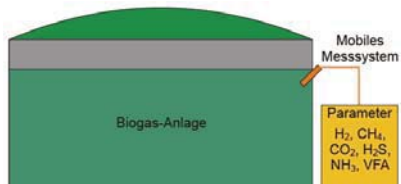
Bild 1: Anordnung der mobilen Biogas-Versuchsanlage VESBA zur Erfassung und Optimierung wesentlicher Prozessparameter unmittelbar neben einer großtechnischen Biogas-Anlage
