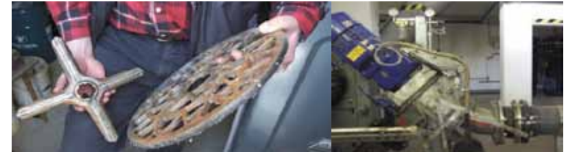
Abbildung 2: Nass-Zerkleinerer (hier RotaCut von Vogelsang): Schneidmesser und Schneidsieb (links) und das in Pump- und Leitungssystem eingebaute Gerät (rechts), Quelle: ATB
