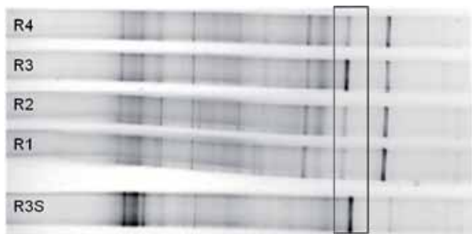
Abbildung 3: Genetisches Fingerprinting der 4 Reaktoren (R1-R4) sowie einer Schaumprobe aus Reaktor 3 (R3S) der Biogasanlage. Banden von Microthrix parvicella sind markiert.
