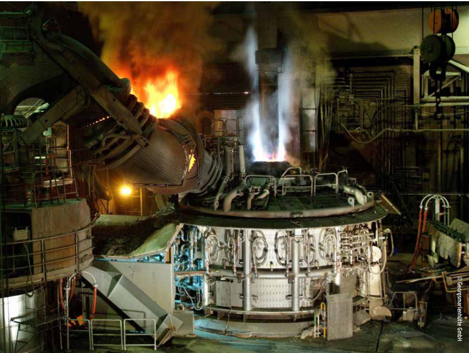
Elektro-Lichtbogenofen zum Einschmelzen von Stahlschrott zur Herstellung von Stahl-Neuprodukten
