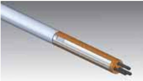
Abbildung 7: Schematische Darstellung des Kopfteils einer Probenahmelanze mit integrierten Sensorelektroden.
