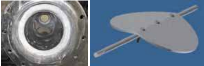
Abbildung 3: Links: Drei Reaktorschichten. Rechts: Beweglicher Pendelrost.
