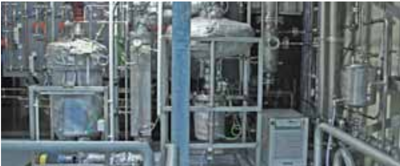
Abbildung 4: Technikumsanlage zum katalytischen Cracken, Ausschnitt (Fettbereitstellung bis Verdampfung, Produkttrennung und -lagerung).
