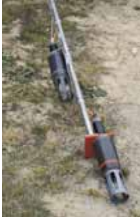
Abbildung 5a: Messlanze mit Messköpfen.
