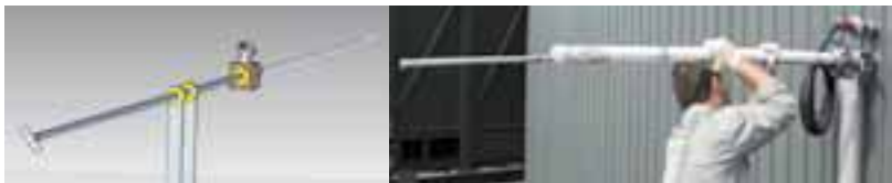
Abbildung 4a (links): Schematische Darstellung einer Probenahmelanze für Biogasfermenter. Das Außenrohr wird über eine Halterung und einen Kugelhahn in den Reaktor eingeführt. Die Probenahmekammer (Kopfteil, orange) wird von außen über ein Einsteckrohr (hier mit Griff) geöffnet und geschlossen.
