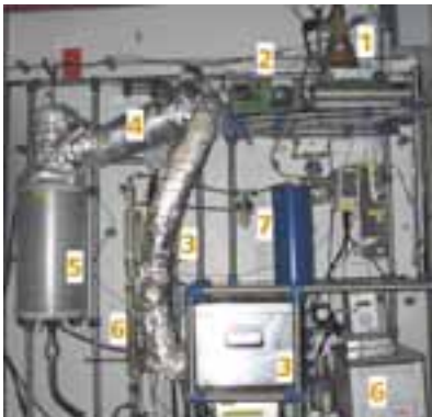
Abbildung 3: Laboranlage zum katalytischen Cracken.
