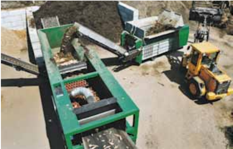
Abbildung 6: Aufbereitung in einem Arbeitsgang, Foto: Komptech.
