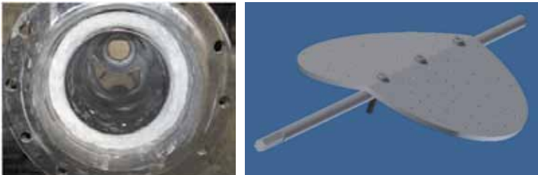
Abbildung 3: Links: drei Reaktorschichten; Rechts: beweglicher Pendelrost
