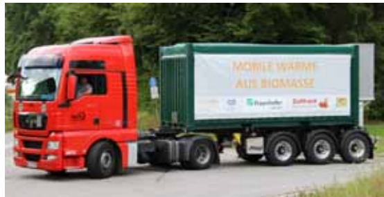
Abbildung 11: Mobiler Latentwärmespeicher in der Erprobungsphase
