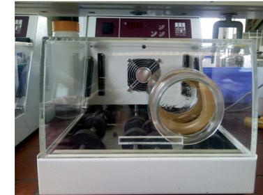
Abbildung 6: Rolleninkubator zur Hydrolyse mit hydrolisierter Maissilage
