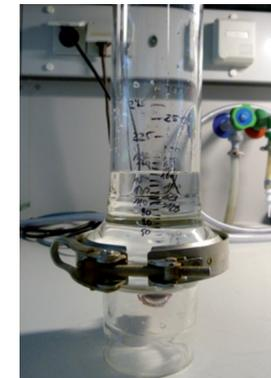
Abbildung 3: Prinzipskizze des Membranteststandes als Laborapparatur und als finale Ausführung mit angepassten Glasschliff und Spanning für Membranaufnahme
