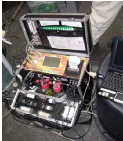
Abbildung 5.4 Produktgasanalysegerät VISIT03H, © HSZG.
