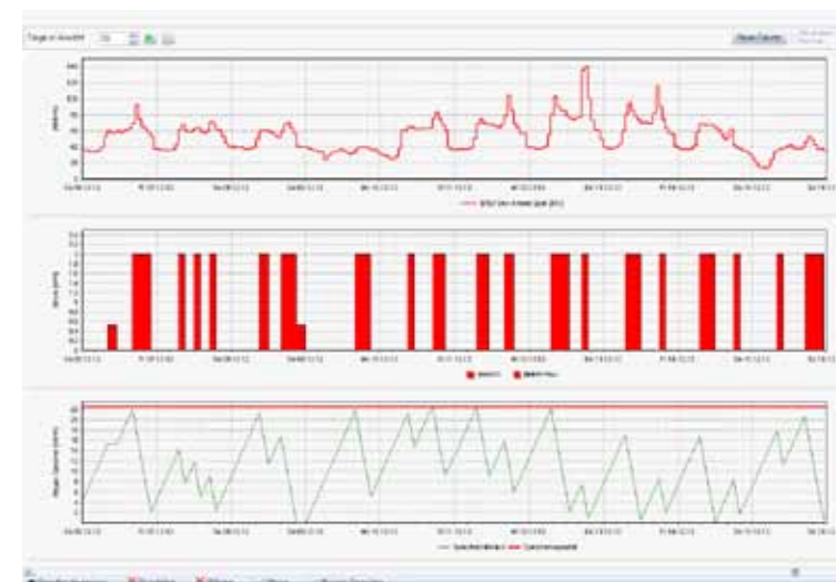
Abbildung 4: Wochenfahrplan: Der Gasspeicher limitiert die Freiheitsgrade. Manchmal muss zu niedrigen Preisen eingespeist werden (Wochenende), manchmal steht für hohe Preise nicht genug Biogas zur Verfügung. (Quelle: CUBE-Simulation mit energyPRO)
