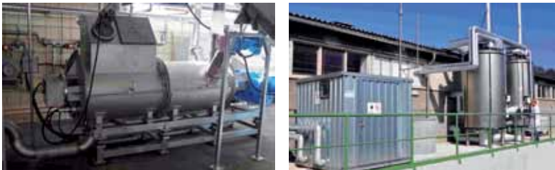
Abbildung 4: Links: Hydrolysereaktor, Rechts: Pilot-Biogasanlage
