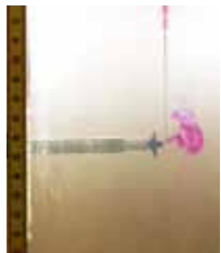
Abbildung 8: Visualisierung des Propellerfreistrahls in einer Xanthanlösung mit 1 g/kg H 2 O bei einer Drehfrequenz von 500 Upm
