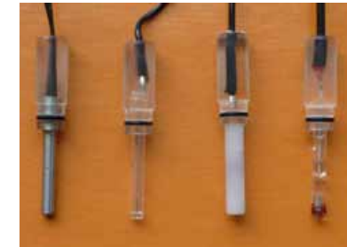
Abbildung 3: Miniaturisierte Elektroden: Links: Temperaturfühler (Pt1000), Redox-(Platin), Referenz- und pH-Elektrode (Glas). Durchmesser: max. 4 mm, Länge: 40 mm. Standzeiten: > 4 Wochen ohne Nachkalibrierung. Rechts: eingebaute in Sensorkopf
