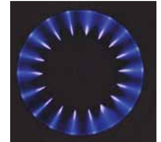
Abbildung 1: Coronaentladung: das leuchtende Plasma tritt aus den Spitzen der sternförmigen Elektrode aus
