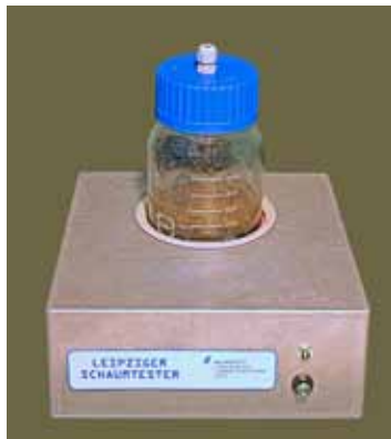
Abbildung 2: LEIPZIGER SCHAUMTESTER - Testset zur Bestimmung der Schaumneigung von Substrat in Biogasanlagen
