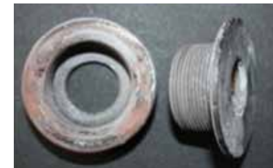
Abbildung 4: Fotografie einer Halterung für die Katalysatorproben zur Installation im Abgastrakt eines BHKW
