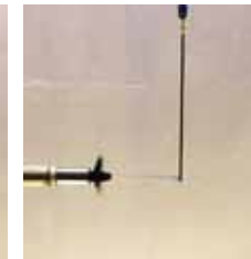
Abbildung 5: Visualisierung des Propellerfreistrahls in Invertzuckersirup bei einer Drehfrequenz von 3000 Upm
