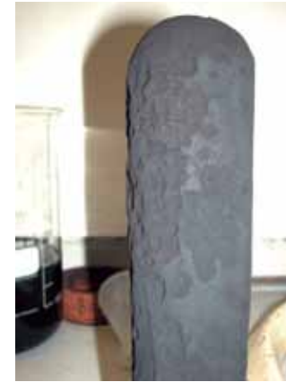
Abbildung 3: Filterelement mit unvollständig abgereinigtem Filterkuchen. Differenzdruck kann im weiteren Betrieb unzulässig hoch ansteigen (Sitzmann 2009)
