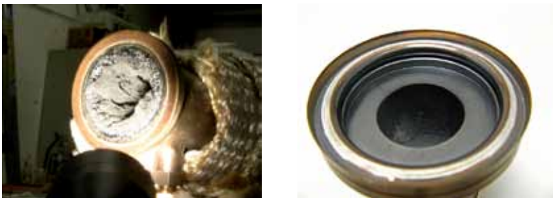
Abbildung 1: Rohrleitungen bei der Pyrolyse von Buchenholz. Ohne (links) und mit (rechts) einer Heißgasfiltration bei Prozesstemperatur
