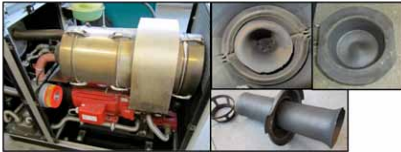
Abbildung 11: Stirlingmotor-BHKW vor dem Umbau - Rechts: Erhitzer, Prallplatte und Mischer-Rohr
