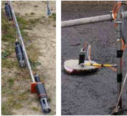
Abbildung 1: Multipositionssensorlanze. Drei Messköpfe mit je drei Elektroden (T, pH, RedOx) sind untereinander an einer Eintauchlanze angebracht (links). Einbausituation in Hydrolysestufe mit schwimmendem Messkopf auf der Flüssigkeitsoberfläche (rechts).
