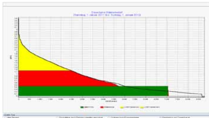
Abbildung 7: Zum Vergleich: Jahresdauerlinie eines konventionell ausgelegten Biomethan-BHKW (Quelle: CUBE-Simulation mit energyPRO)
