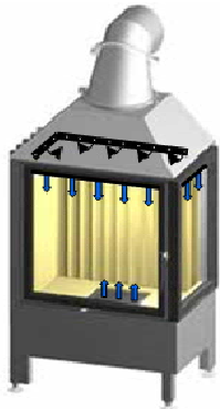
Abbildung 6: Schematische Darstellung der drei Verbrennungsluftströme durch den Feuerrost (Rostluft), entlang der Sichtscheibe von oben (Fensterluft) und über eine Lochleiste von hinten und von der linken Seite (Sekundärluft)
