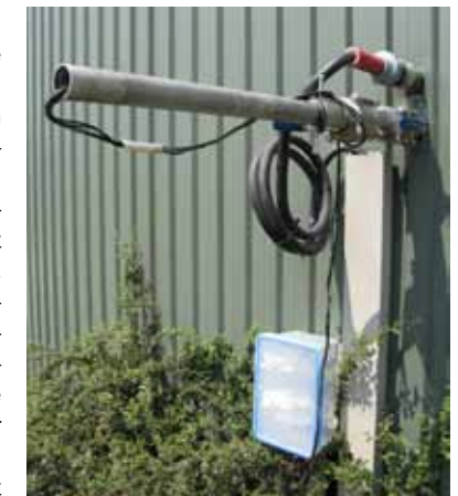
Abbildung 4: Mehrfachelektrodenkopf aufgesetzt auf eine 4-m-Edstahl Lanze (oben). Einbausituation am Fermenter mit Kabelanschluss an Kurzstreckenfunk (unten)
