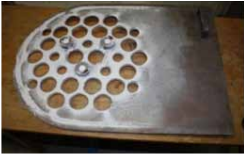
Abbildung 5: Fotografie der Einschubmatrize zur Positionierung der Katalysatorproben im Abgastrakt eines BHKW
