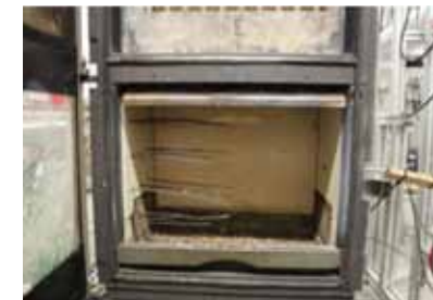
Abbildung 2: Fotografie des Versuchsaufbaus mit Schwämmen (Al 2 O 3 , Größe 1: 90 x 200 x 20 mm)
