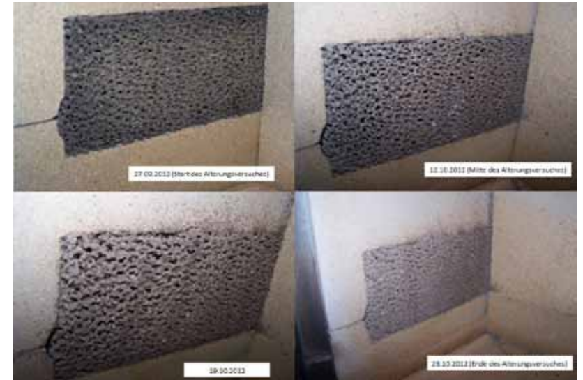
Abbildung 4: Ausgewählte Fotos der Wandkatalysatoren (Größe 1) bei der durchgeführten Alterung unter Praxisbedingungen (Vor-führkaminofen) für ca. 185 h realer Betriebszeit
