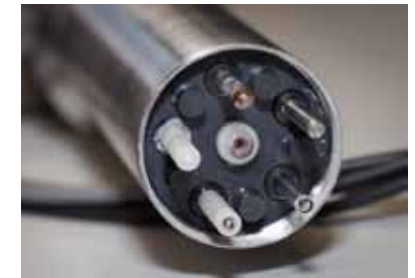
Abbildung 3: Miniaturisierte Elektroden: Links: Temperaturfühler (Pt1000), Redox-(Platin), Referenz- und pH-Elektrode (Glas). Durchmesser: max. 4 mm, Länge: 40 mm. Standzeiten: > 4 Wochen ohne Nachkalibrierung. Rechts: eingebaute in Sensorkopf
