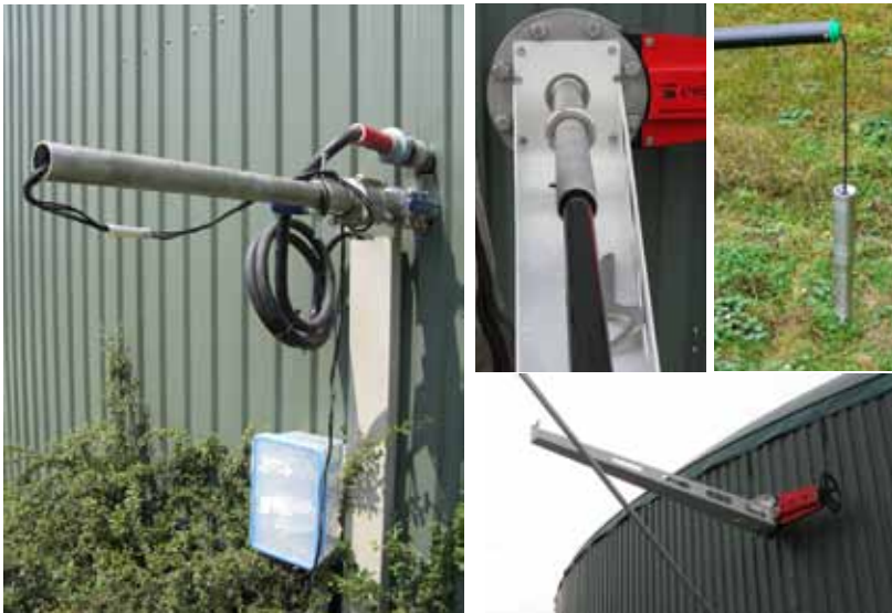
Abbildung 4: Mehrfachelektrodenkopf aufgesetzt auf eine 4 m-Edelstahl-lanze (links, oben). Einbausituation am Hauptvergärer (bodennah) mit Kabelanschluss an Kurzstreckenfunk (links, unten). Gleicher Elektrodenkopf hängend an Kunststofflanze (rechts, oben). Einbausituation am Kopf des Hauptvergärers (mitte rechts, oben). Die Lanze wird auf einer Schiene (rechts, unten) aufgelegt und in die Flüssigphase geschoben (Horizontalverschiebung). Der Elektrodenkopf kann dann innerhalb der Flüssigphase abgesenkt werden (Vertikalverschiebung). Es ergibt sich ein drei-dimensionales Abbild der Verhältnisse in der Flüssigphase.
