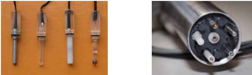
Abbildung 3: Miniaturisierte Elektroden Links: Temperaturfühler (Pt1000), Redox-(Platin), Referenz- und pH-Elektrode (Glas). Durchmesser: max. 4 mm, Länge: 40 mm. Standzeiten: > 4 Wochen ohne Nachkalibrierung. Rechts: eingebaut in Sensorkopf
