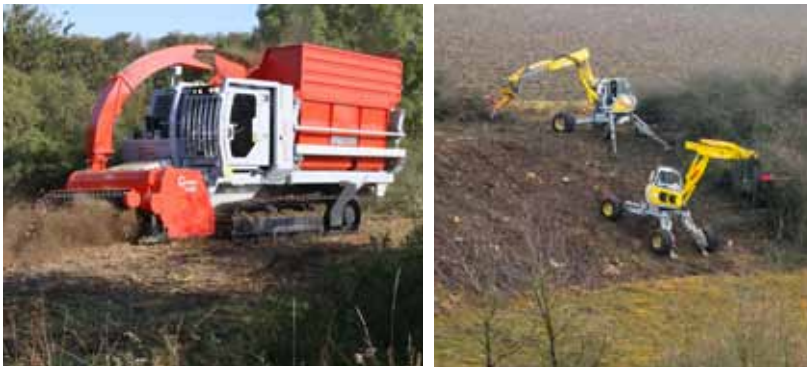
Abbildung 3: Einsatz der hochmechanisierten Verfahrensketten „aufnehmender Mulcher“ (links) und Schreitbagger (rechts; Foto: Naturstiftung David und Seeber, Hildburghausen)
