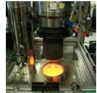
Abbildung 9: Der beheizte Strahler mit dem ausgefahrenen Stirlingmotor
