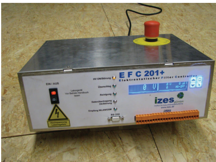
Abbildung 1: Kontrolleinheit des E-Filters
