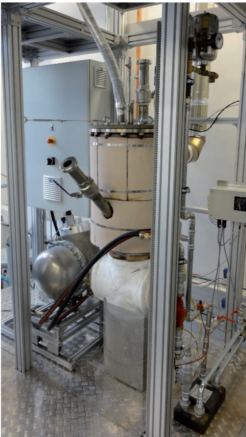
Abbildung 1: 100 kW Wirbelschichtfeuerung mit Stirlingmotor im Technikum des Lehrstuhls für Energieverfahrenstechnik
