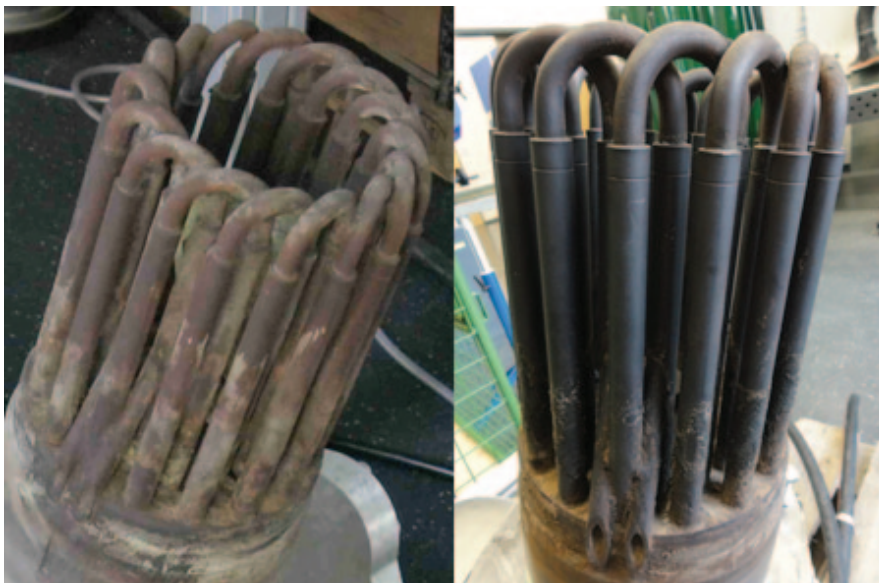
Abbildung 2: Wärmeübertrager des Stirlingmotors nach dem Einsatz in einer Biomassefeuerung als Rauchgaswärmeübertrager (links), und nach den Experimenten an der Wirbelschichtfeuerung als Tauchheizfläche (rechts)
