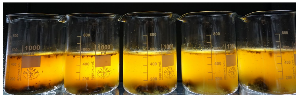
Abbildung 1 Versuchsreihe im Jar-Tester
