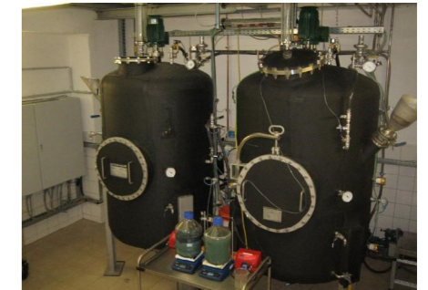
Abbildung 3 Zweistufige Technikumbiogasanlage im 2 m 3 -Maßstab am DBI
