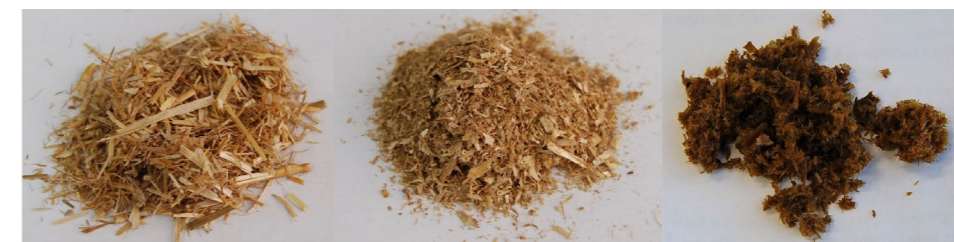
Abbildung 1 Unbehandeltes (gehäckselt); mechanisch desintegriertes (trocken extrudiert/gemahlen) und mechanisch-chemisch desintegriertes (trocken extrudiert + Einweichen in Natronlauge) Winterweizenstroh.
