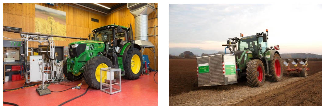
Abbildung 1 Rapsöлтаugliche Traktoren bei Emissionsmessungen am Prüfstand (links) und im Feld mit portabler Emissionsmesstechnik (rechts)
