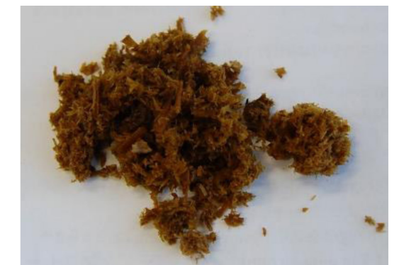
Abbildung 2: Forschende des DBFZ haben Weizenstroh gemahlen und mit Natronlauge eingeweicht.
