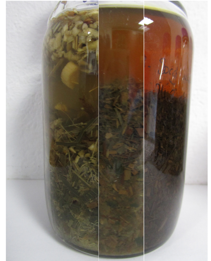
Abbildung 4: Der thermische Aufschluss im Autoklaven bei 160 °C (Mitte) und 190 °C (rechts) führte zu einer Veränderung der physikalischen Eigenschaften der Sorghumsilage. Im Vergleich zur Referenz (links) sanken leicht aufschwimmende Partikel ab. (Quelle: DBFZ)
