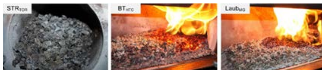
Abbildung 2: Verschlackungen in der Feuerraumasche während der Verbrennung von torrefizierten Strohpellets (STR TOR ), hydrothermal carbonisiertem Biertreber (BT HTC ) und mechanisch gewaschenen Laubpellets (Laub MG ).
