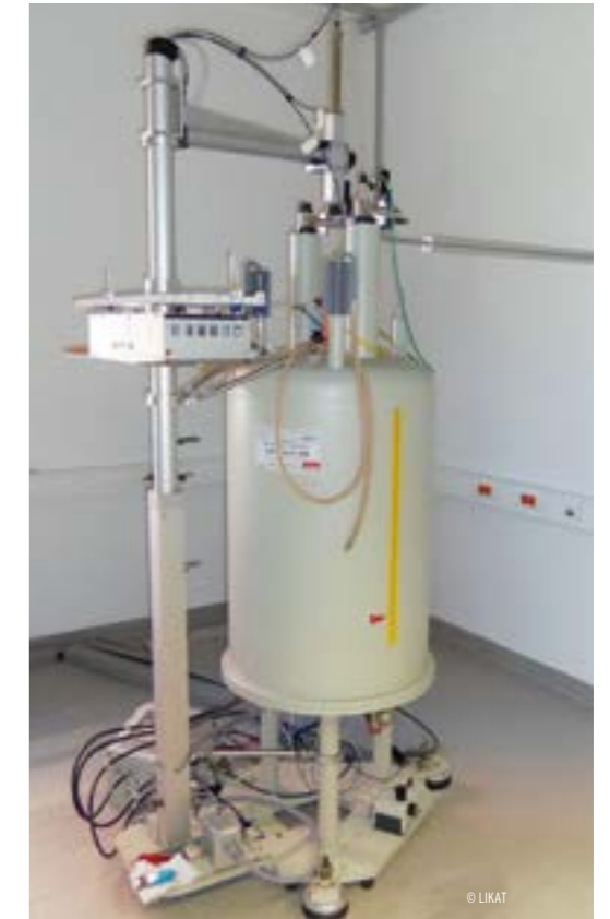
Ein 400 MHz-Kernspinresonanzspektrometer am LIKAT
