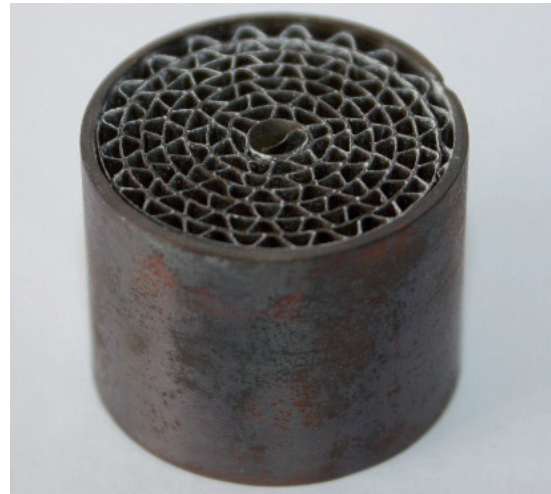
Abbildung 1: Katalysatorprobenkörper, der im Projekt zum Einsatz kam
