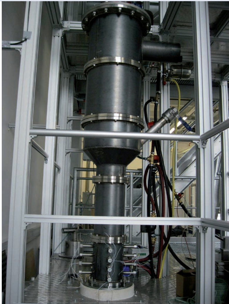
Abbildung 4: Wirbelschichtfeuerung für Verbrennungs- und Verschlackungsversuche am Lehrstuhl für Energieverfahrenstechnik
