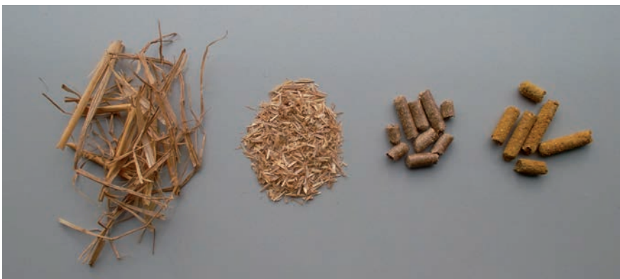
Abbildung 3: Stroh unbehandelt, nach Hammermühle, pelletiert und mit NaOH pelletiert
