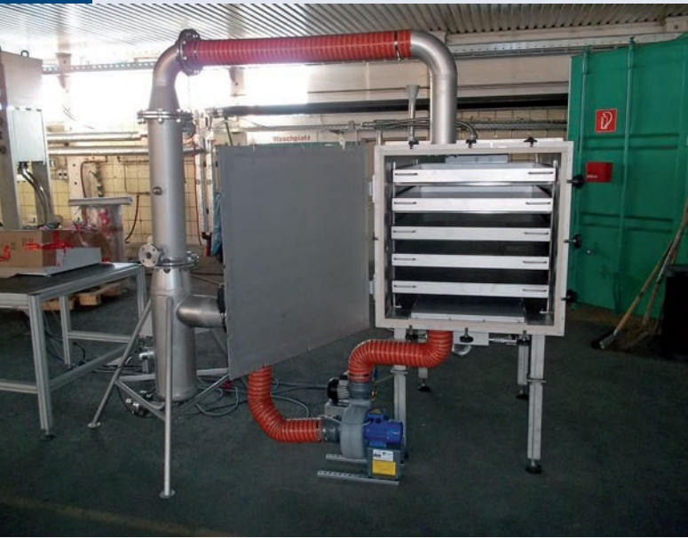
Abbildung 4: Kleintechnischer Trockner mit Brüdenrückgewinnung
