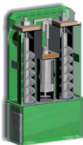
Abbildung 1: 3D-Schnitt des Carola®-Abscheiders für holzgefeuerte Heizkessel
