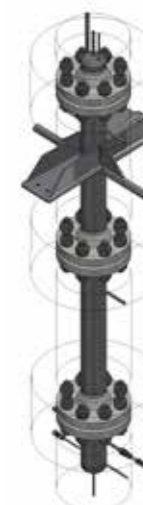
Abbildung 2: Zweistufige Biogasanlage im 2m³-Maßstab am DBI (links) und Schema des Reaktors zur Methanolsynthese (rechts)
