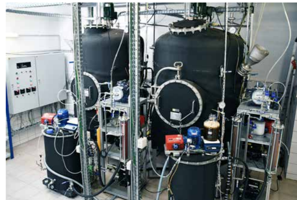
Abbildung 2: Zweistufige Biogasanlage im 2m³-Maßstab am DBI (links) und Schema des Reaktors zur Methanolsynthese (rechts)
