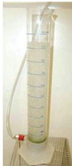
图 27：采用泡沫发生模型的泡沫发生装置
