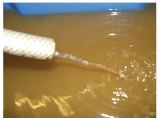
图 67：完成湿筛法后的溢流（资料来源：施耐德[Schneider], 2010）
