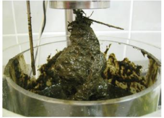
图 35：长纤维底物组分缠绕搅拌器轴（资料来源：布雷默）
