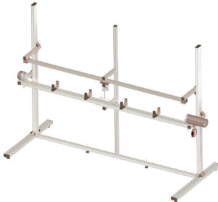
图 54: 用于校准和确定薄膜传感器常数的牵引通道
