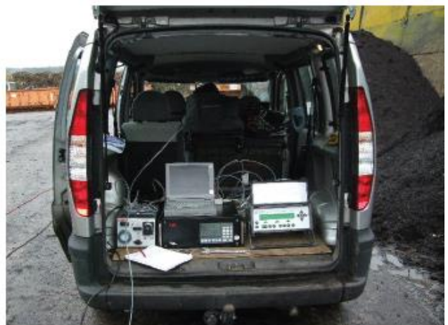
配备采样泵与分析仪的排气测量技术以及在线获取测量值。
