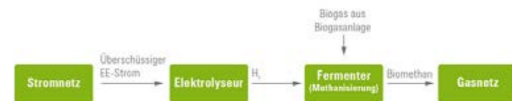
Abbildung 2: BioPower2Gas-Anlage mit einer Flexibilisierung durch Erweiterung einer Biogasanlage um einen Elektrolyseur und Fermenter
