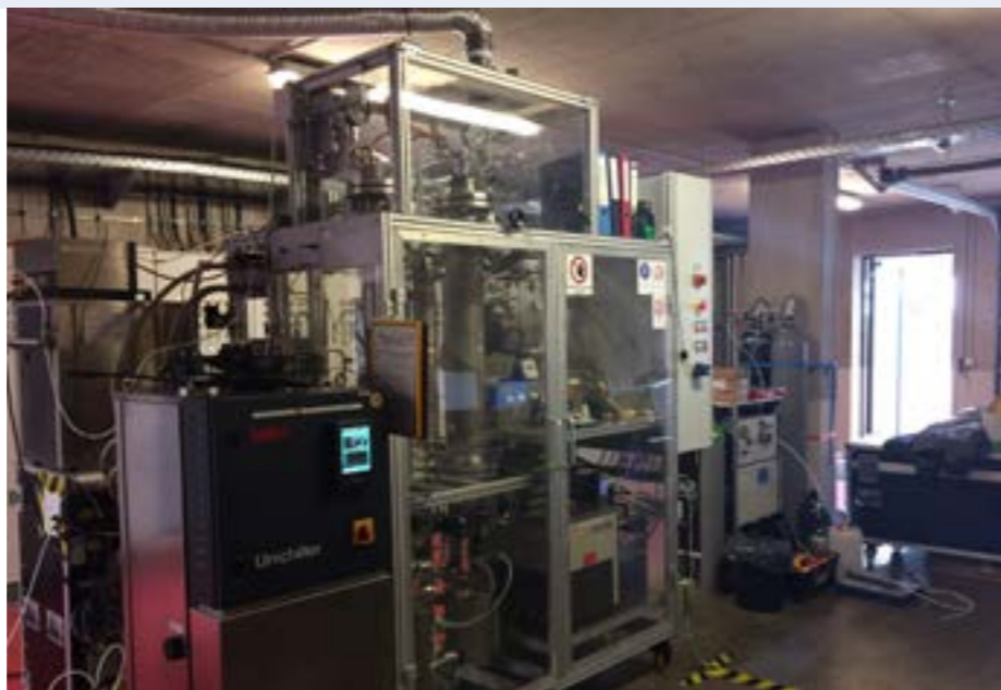
Abbildung 3: Realgaskampagne mit dem entwickelten Aufbereitungsverfahren an der Biogaseinspeiseanlage der Powerfarm Bioenergie GmbH in Tübingen, Quelle: DVGW
