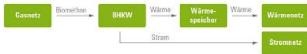
Abbildung 3: Biomethan-BHKW mit einer Flexibilisierung durch Auslegung mit größerem BHKW und Ergänzung um einen Wärmespeicher
