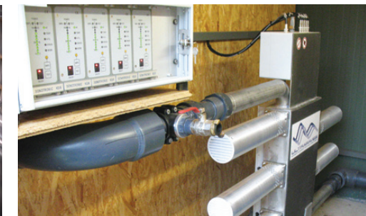
Desintegration von Biomasse mittels Ultraschall der Fa. Ultrawaves zur Intensivierung des anaeroben biologischen Abbaus, Quelle: ULTRAWAVES GmbH
