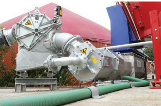
Flüssigfütterung der Fa. Vogelsang, bestehend aus dem EnergyJet zum Anmischen von Substraten mit Gülle/Rezirkulat und dem RotaCut-Lochscheibenzerkleinerer für die weitere Aufbereitung, insbesondere empfehlenswert für langfaserige Substrate wie Mist und Grassilage, Quelle: Hugo Vogelsang Maschinenbau GmbH
