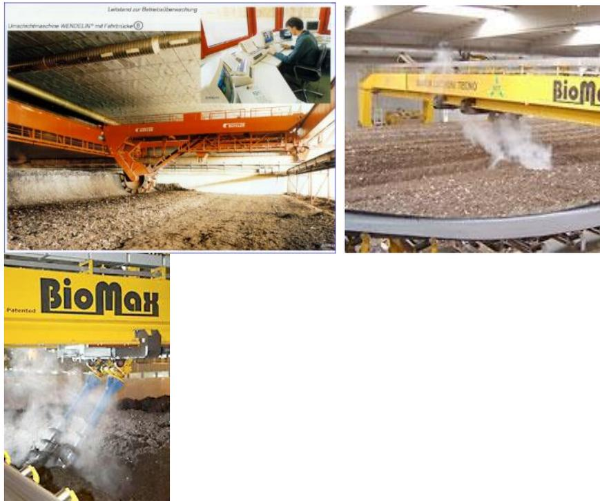
Abbildung 4-4: Umsetzer Fa. Bühler (links), Fa. SCT (rechts)
