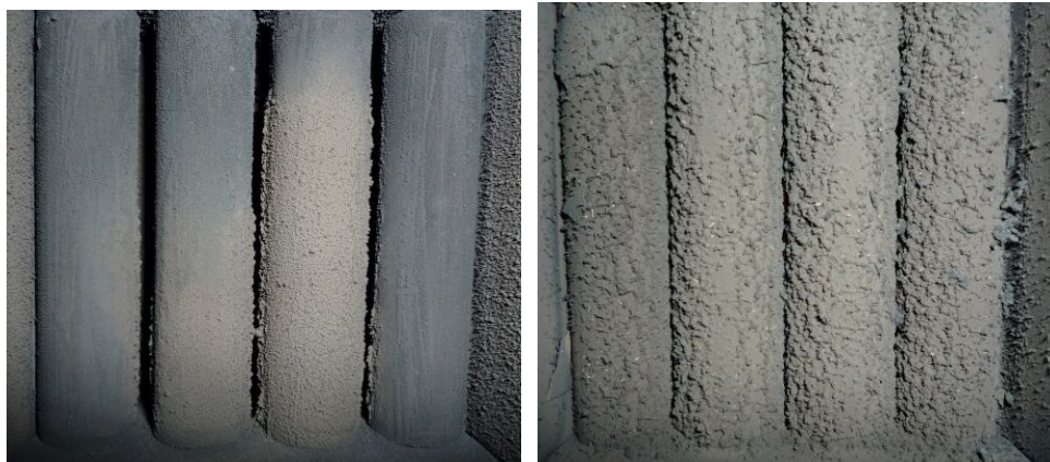
Abbildung 35: Beladener Wärmeübertrager. Anströmseite (links) und Abströmseite (rechts)
