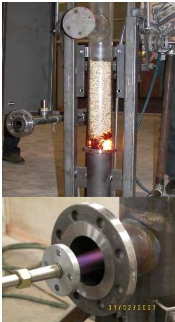
Abbildung 2.1: Erste Pyrolyseversuche mit Glasröhren
