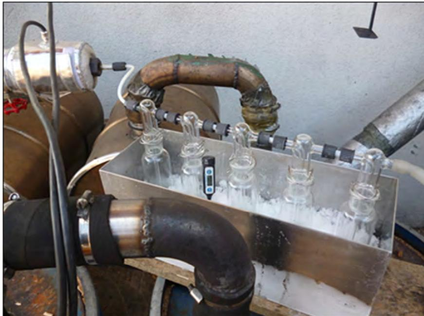
Abbildung 4.26: Teerprobenahme in Anlehnung an DIN CEN/TS 15439
