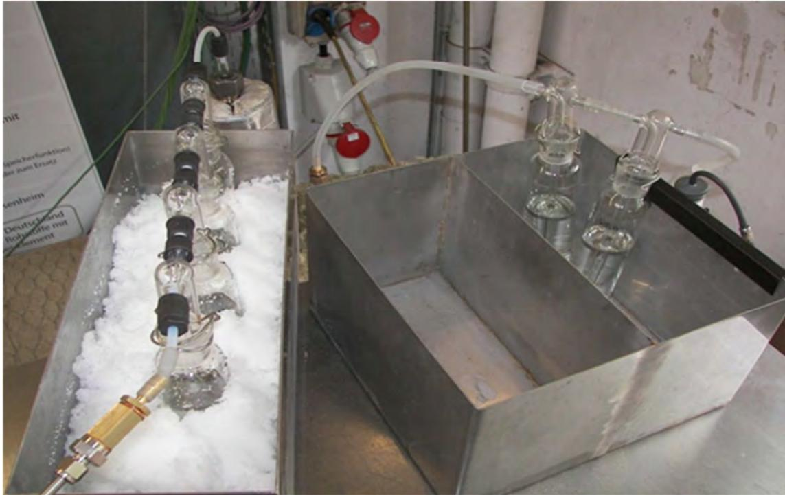
Abbildung 4.22: Waschflaschenkolonne der nasschemischen Teermessung (links) und Gasreinigung für die Permanentgasmessung (rechts)
