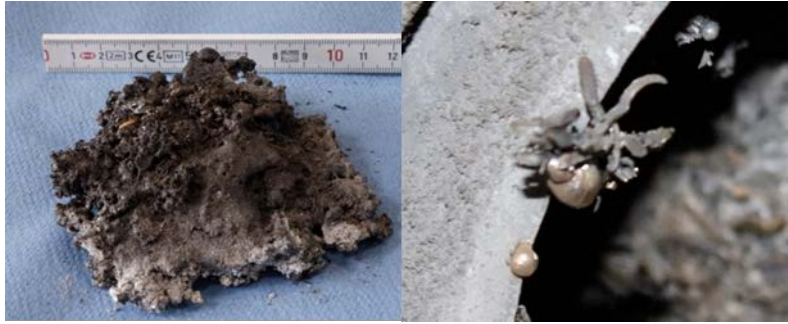
Abbildung 26: Gesinterte und verglaste Miscanthus-Rückstände
