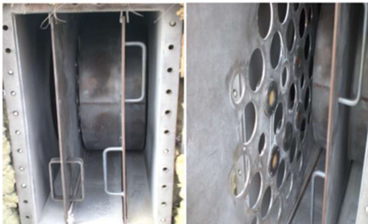
Abbildung 53 Fotografien der eingebauten Einschubmatrize bestückt mit Probenträgern links neben dem Formaldehydkatalysator
