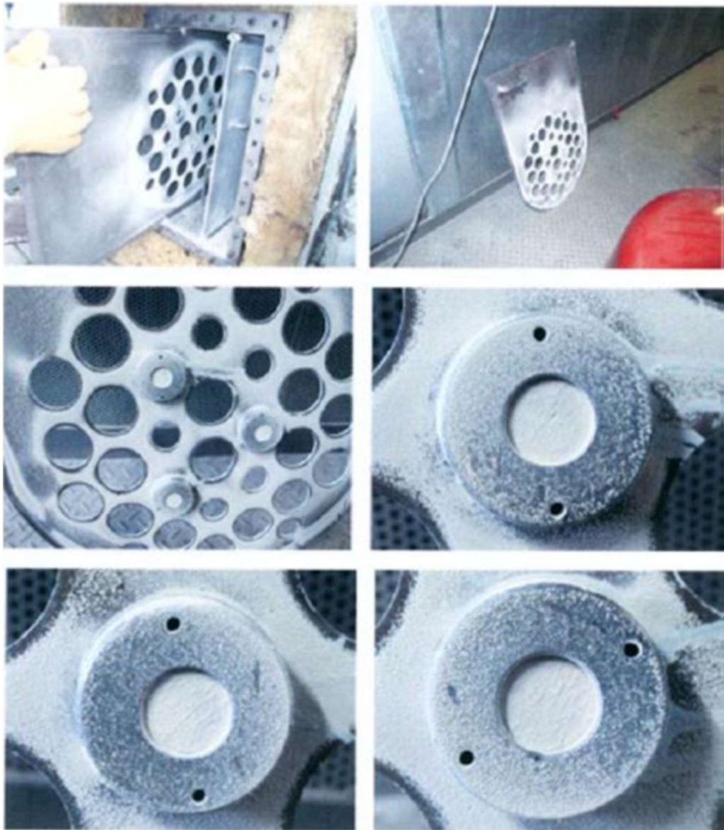
Abbildung 54 Fotografien der mit Staub bedeckten Einschubmatrize und Staubprobenahmefilter unmittelbar nach Ausbau aus dem BHKW Sprotta
