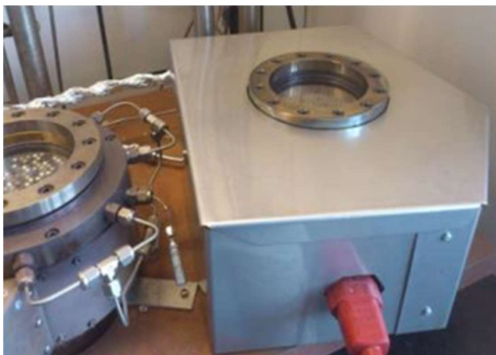
Abbildung 2 rechts: IR-Reaktor mit Metallgehäuse zur Isolierung und beheizte Gaszuführung für befeuchteten Gasstrom im Hintergrund; links partiell abgebildet: radiale Gaszuführungen
