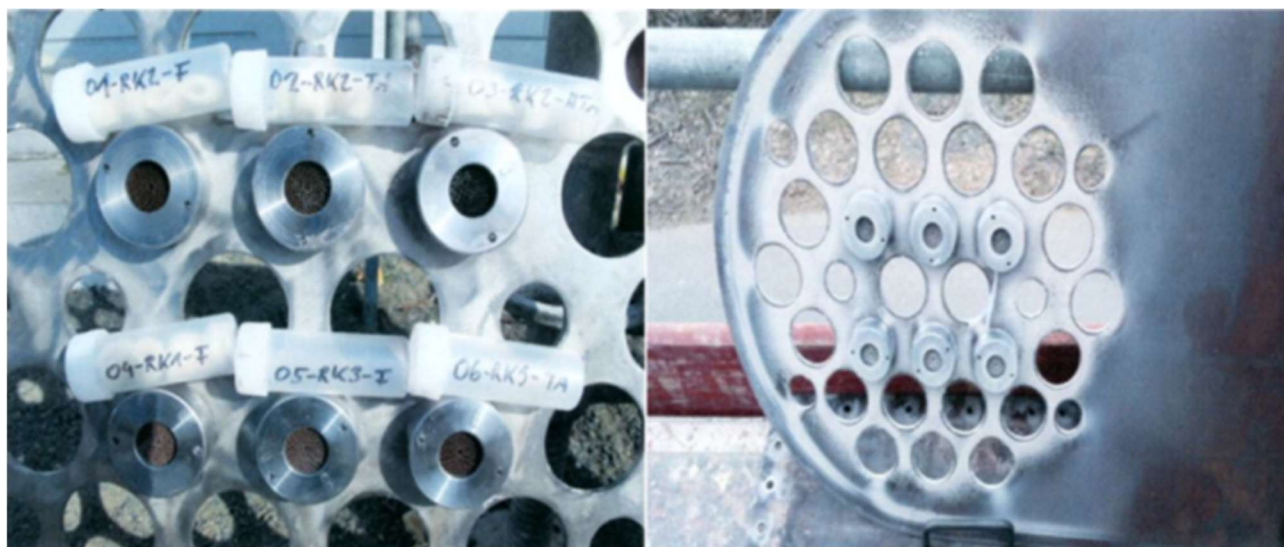
Abbildung 58 Fotografien der in die Träger eingebauten Katalysatorproben (links: frisch; rechts: nach 661 Betriebsstunden)
