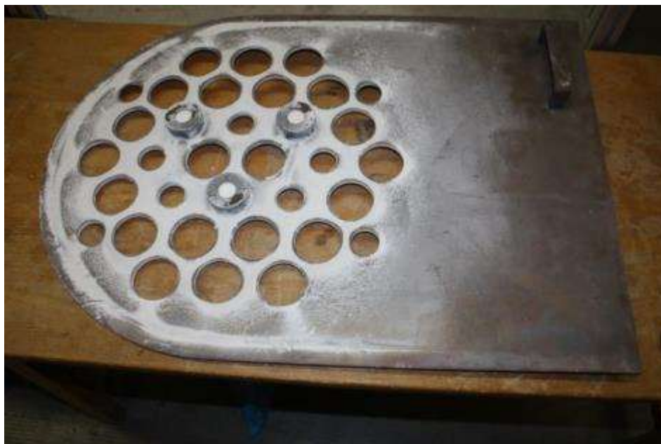
Abbildung 44 Fotografie der Einschubmatrize mit den Katalysatorhalterungen nach dem Ausbau aus dem Abgaskanal des BHKW Sprotta nach 98 Tagen mit deutlich erkennbaren Staubablagerungen über der gesamten Matrize und den Staubprobenahmefiltern
