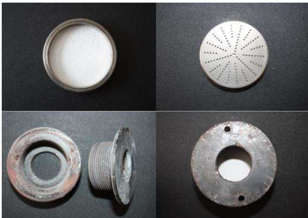
Abbildung 43 Oben links: Filter im Filterhalter wie dieser für standardmäßige Staubprobenahme durch das DBFZ verwendet wird (Anströmseite); Oben rechts: Filter im Filterhalter wie er für standardmäßige Staubprobenahme durch DBFZ verwendet wird (Abströmseite); Unten links: durch CES angefertigte Katalysatorhalterung zum Anbringen an eine entsprechende Einschubmatrize für den Abgaskanal des BHKW; Unten rechts: In der Katalysatorhalterung installierter Staubprobenahmefilter
