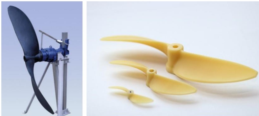
Abb. 34 Skalierung großtechnischer Rührtechnik (Quelle: www.ksb.com ) in den Labor- und kleintechnischen Maßstab (IKTS 2014)
