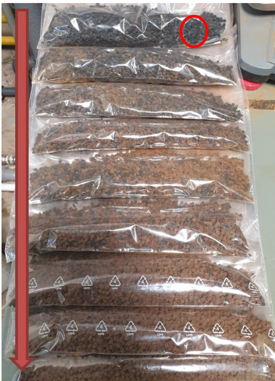
Abbildung 35: Katalysatorschüttung schichtweise entleert, Gasanströmung von oben (Pfeil), Versuch UT03Z09T00
