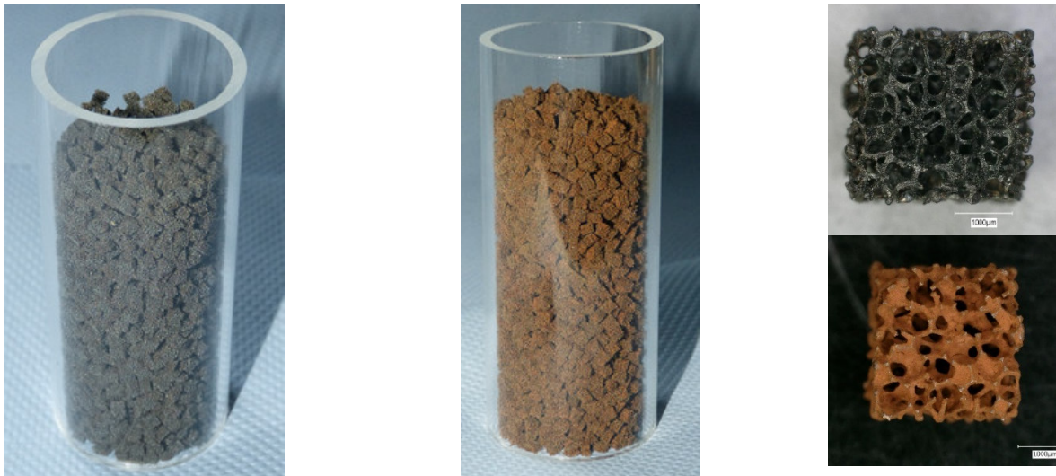
Abbildung 10: Pelletchargen vor (grau) und nach (braun) der Beschichtung mit Adsorbensmaterial mittels Dip-Spin-Coating (Quelle IKTS)
