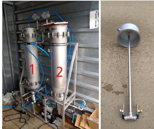
Abbildung 34: Versuchsanlage, Bubbler (1) und Adsorber (2) und (links); Begasungsrohr Bubbler (rechts)
