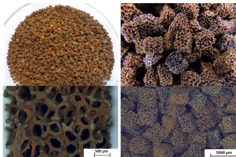
Abbildung 14: gebrauchtes Adsorbentmaterial vor der Abtragsbehandlung (Quelle Alantum)
