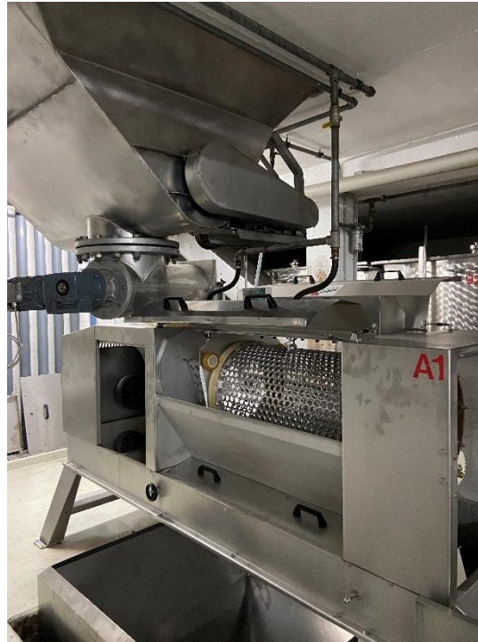
Abbildung 6: Trommelpresse für Trennung des flüssigen Anteils vom Trester bei der Weißweinherstellung
