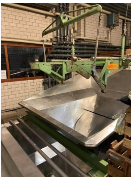
Abbildung 3: Entrapper (links Einführungstrichter; rechts Schneidwerkzeug)
