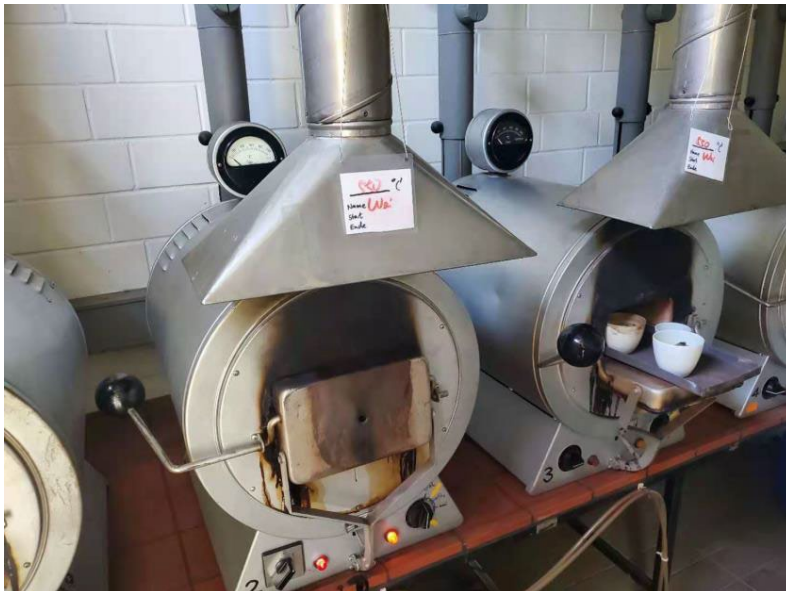
Abbildung 3-10 Muffelofen bei 550°C
