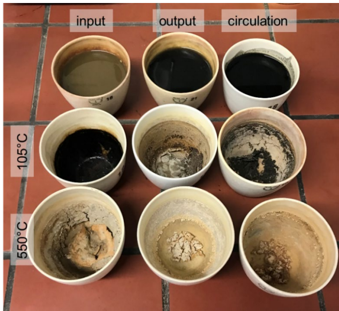
Abbildung 3-11 Proben vor der Trocknung & nach der Trocknung bei 105 °C & nach der Verbrennung in einem Muffelofen bei 550 °C
