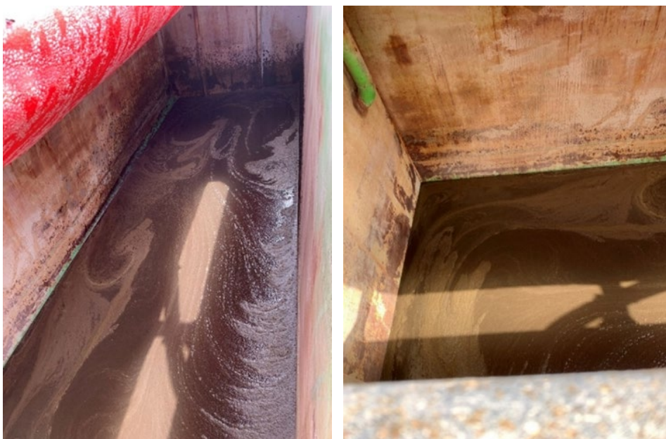
Abbildung 4-6 Presswasser (mit Leitungswasser angemischt)
