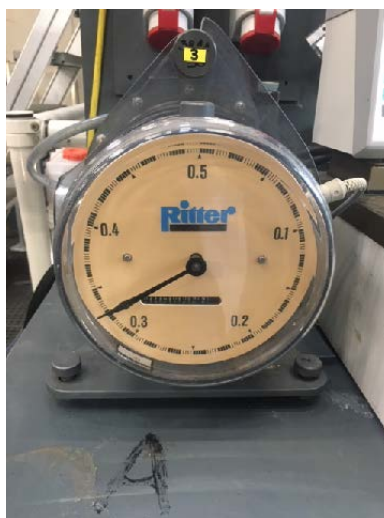
Abbildung 3-16 Trommelgaszähler Firma Ritter - Halb technische Untersuchung
