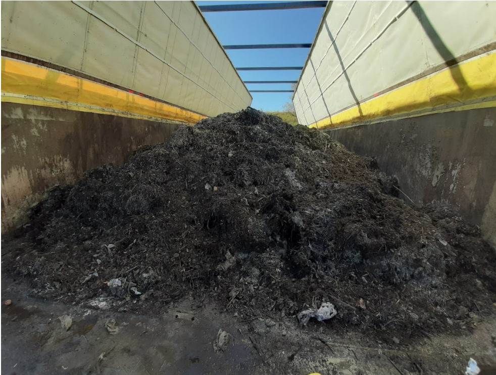
Abbildung 4-29 Auslagerung aus der Intensivrotte nach 14 Tagen
