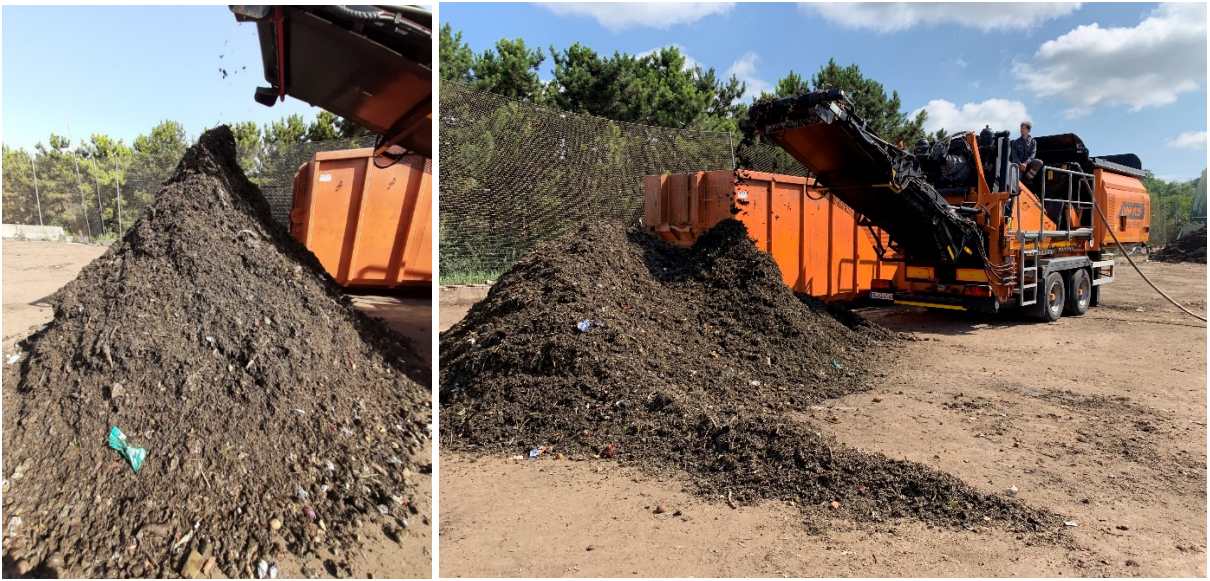
Abbildung 4-3 Abgepresster Bioabfall (< 80 mm)
