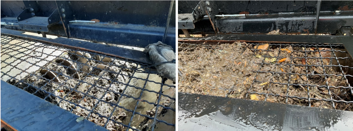
Abbildung 4-2 Angemischter Bioabfall mit Sickerwasser in Presse
