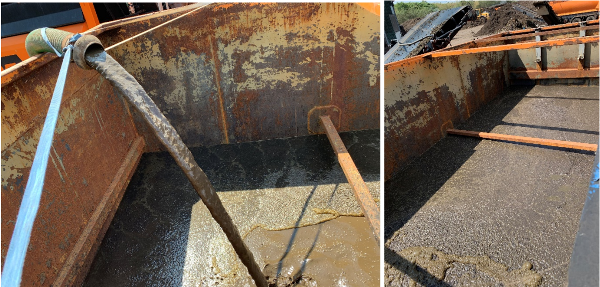
Abbildung 4-4 Presswasser (mit Sickerwasser angemischt)
