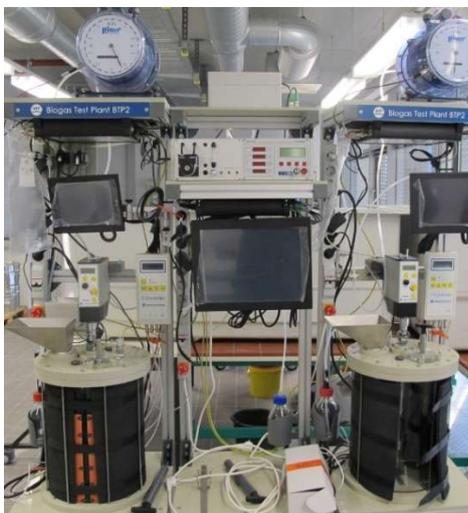
Abbildung 52: Laborbiogasanlage „BTP2“ des Fachbereichs Wasser, Umwelt, Bau und Sicherheit der HS
