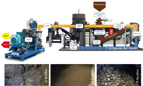
Abbildung 1: Holzgas-BHKW-Anlage der Fa. Spanner Re 2 GmbH (oben) und Vergaserkoke aus drei verschiedenen Vergasungsanlagen (unten)
