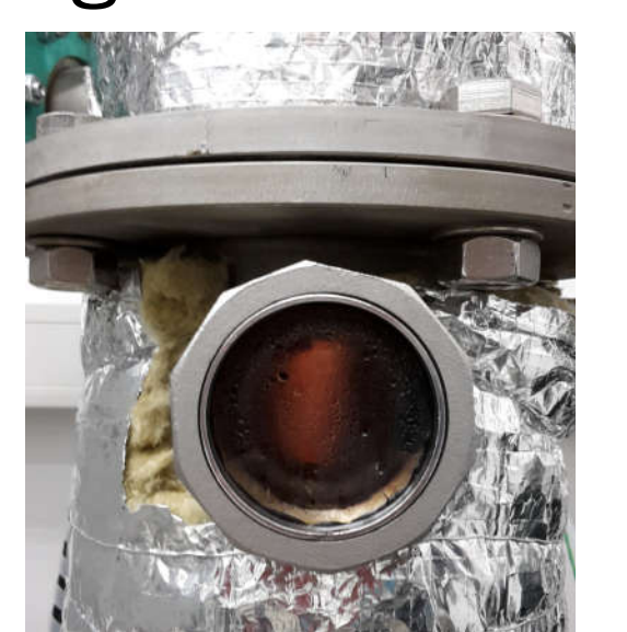
Abb. 3: Sekundärzone des Prototyps mit Flamme
