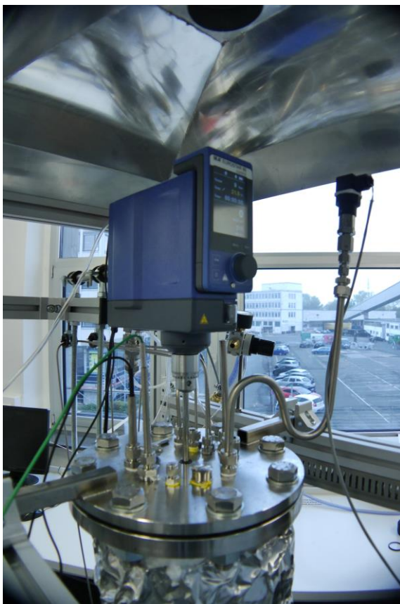
Bild 2: Aufnahme des druckaufgeladenen Laborfermenters an der FAU (Quelle: FAU)
