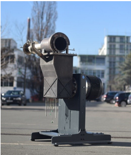
Bild 2: Aufbau der Mikro-KWK-Anlage (Darstellung ohne Isolierung und Instrumentierung) (Quelle: FAU)
