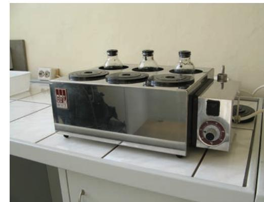
Thermostat zur Beheizung diskontinuierlicher Gärversuche (durch IOPC bereitgestellt)
