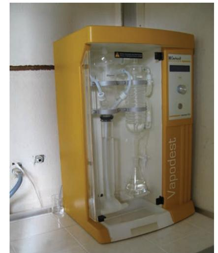
Destillationseinheit zur Bestimmung des Ammonium-Stickstoff-Gehaltes
