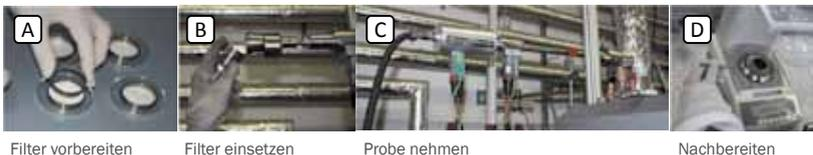
Abbildung 14: Beispielhafter Ablauf einer gravimetrischen Gesamtstaubprobenahme nach VDI 2066 Blatt 1, wie sie für Untersuchungszwecke im Labor durchgeführt wird. A: Vorbereitung des Planfilters, vgl. dazu SOP in der Anlage, B: Einsetzen des vorbereiteten Filters in die Probenahmesonde, C: Abbildung der fertigen Probenahmesonde, D: Nachbehandeln der beladenen Filterprobe, insbesondere das Auswiegen zur Bestimmung der Beladung.
