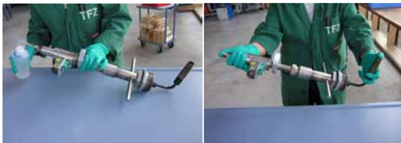
Abbildung 3: Spülen der Probenahmesonde mit destilliertem Wasser und Aceton, links: Einfüllen der Flüssigkeit in die Sonde, rechts: Verteilen der Flüssigkeit in der Sonde durch Schütteln und Zuhalten beider Öffnungen
