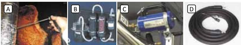
Abbildung 6: Abbildungen zur Teilgasstromentnahme, A: unbeheizte Sonde zur Gasprobeentnahme, B: Kondensatfalle zur Entfernung des Wassers aus der Gasphase sowie Filterpatronen (Aktivkohle und Natriumpermanganat) (Foto: Eheim Messtechnik), C: beheizte Sonde zur Gasprobeentnahme, D: beheizte Probeentnahmeleitung (Foto: Eismann & Ströbe GbR)
