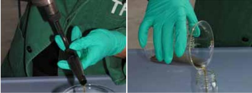
Abbildung 4: Spülen der Probennahmesonde, links: Entleeren der Probennahmesonde in ein großes Becherglas, rechts: Umfüllen der gesamten Spülflüssigkeit (destilliertes Wasser und Aceton) in einen bereits eingewogenen Spülbehälter; Bild: TFZ
