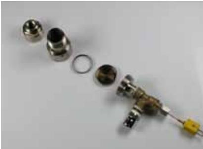
Abbildung 1: Filterhalter für Planfilter und Filterhülsen der Firma Paul Gothe; Bild: TFZ
