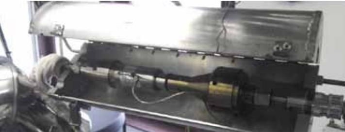
Abbildung 3: Hülsen- und Planfilterhalter im Heizgehäuse (mit Temperaturmessung); Bild: ZAE Bayern
