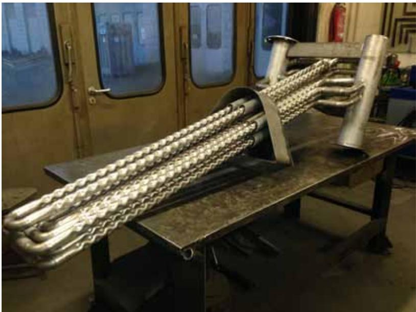
Abbildung 9: Der HT-WT in Vorbereitung für den Einbau in den Kessel
