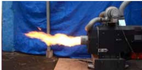
**Abbildung 2** Verbrennungsversuch mit torrefizierten Pellets in einem Gewächshaus (FFPRI, Takahiro Yoshida)
