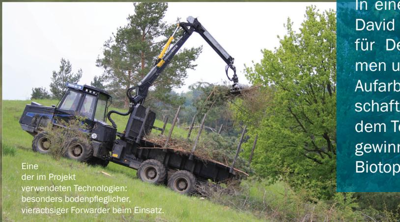
Eine der im Projekt verwendeten Technologien: besonders bodenpfleglicher, vierachsiger Forwarder beim Einsatz.
