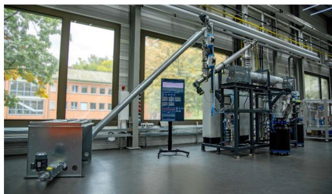
Abbildung 1 (links): Technikums-Anlage für die thermochemische Konversion biogener Reststoffe in regeneratives Rohöl bei Fraunhofer UMSICHT in Sulzbach-Rosenberg
