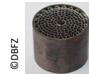
Monolithische Katalysatorprobe: D: 25,4 mm; L: 20 mm
