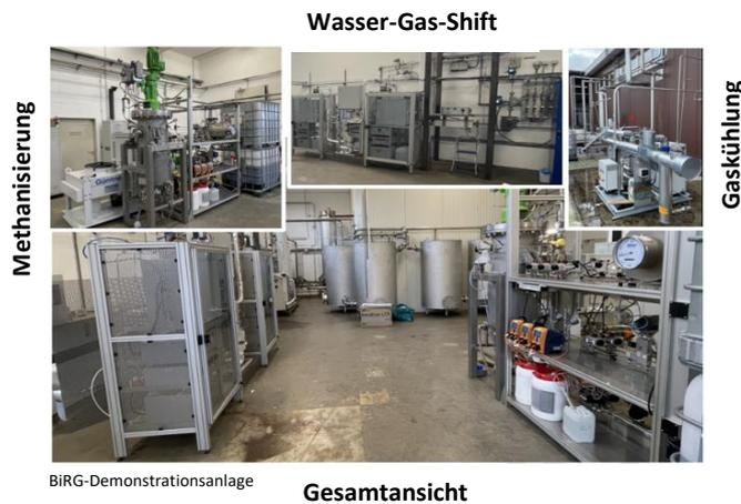
Verbundvorhaben: BiRG - Umwandlung biogener Reststoffe in Produktgas durch Pyrolyse, Shift und mikrobielle Methanisierung
